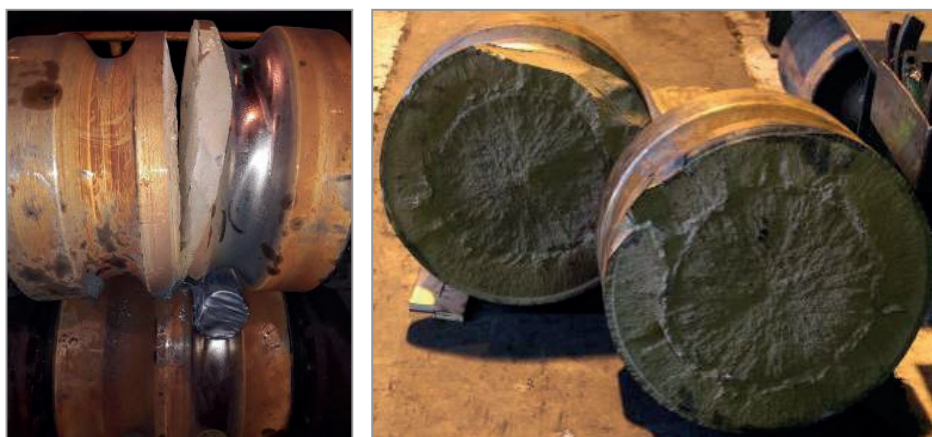
Рис. 1. Внешний вид разрушенного валка и характер разрушения
