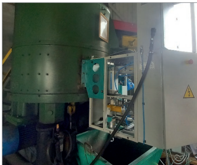
Рис. 2. Настройка и испытания устройства на вихревом смесителе в ОАО «БЕЛНИИЛИТ»
