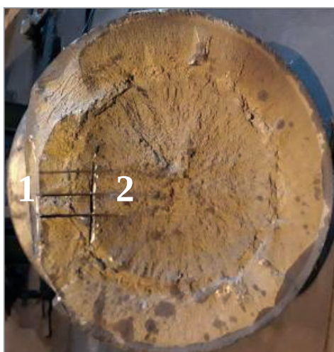
Рис. 2. Зоны излома валка: 1 – подповерхностная; 2 – центральная
