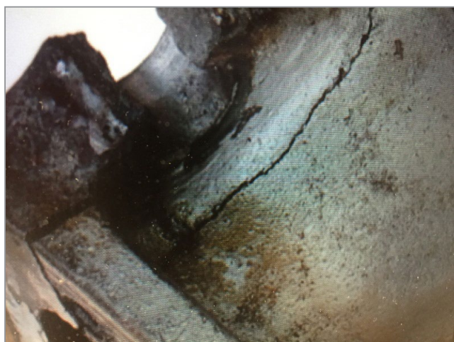
Рис. 3. Трещина в отливке «станина», возникшая в месте сопряжения ребра жесткости с конструктивным приливом
